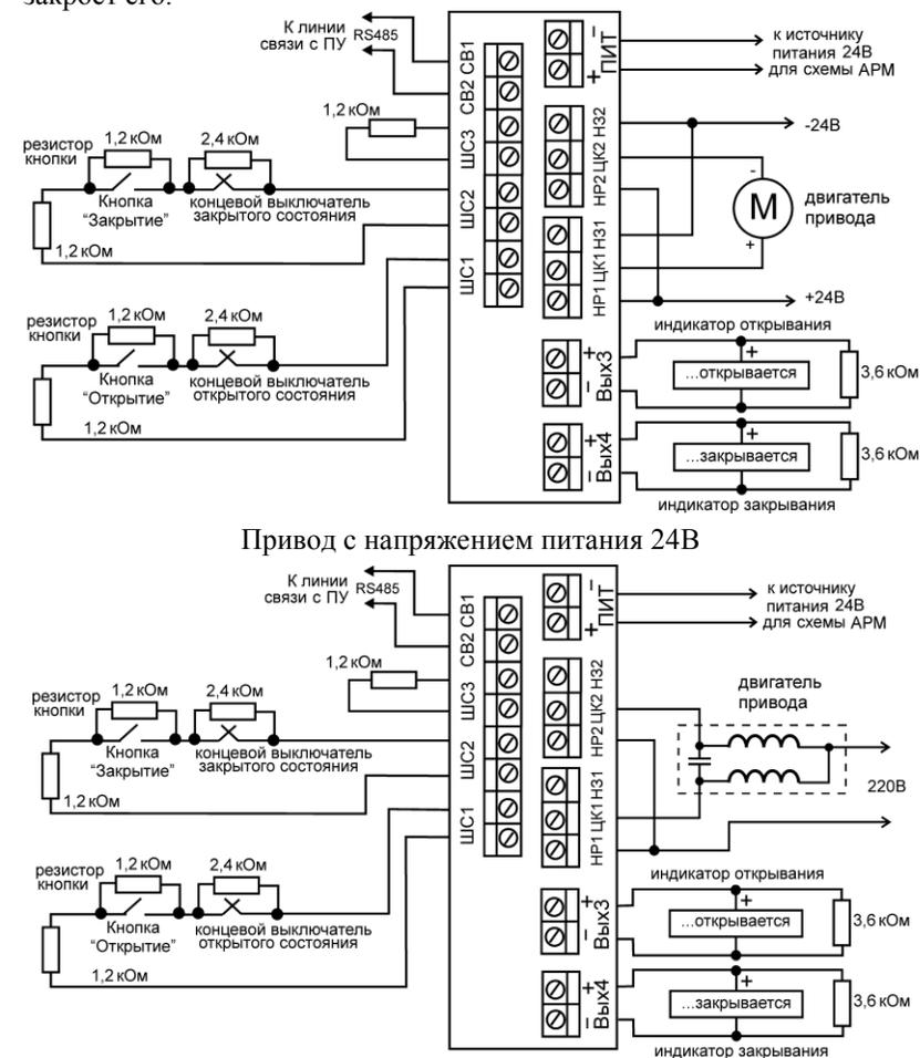
Рис.5 – Схемы подключения АРМ в режиме 3
