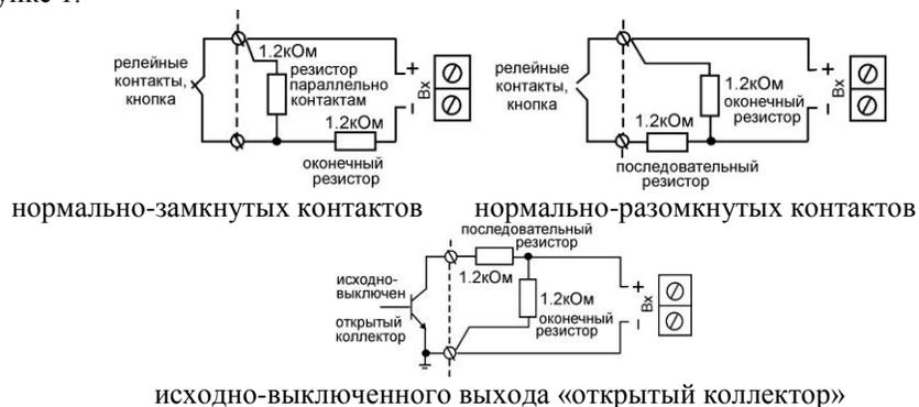
Рис.1 – Схема подключения контактов к технологическим шлейфам
