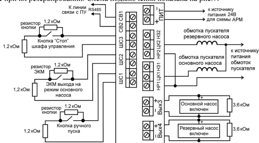
Рис.7 – Схема подключения АРМ в режиме 5
