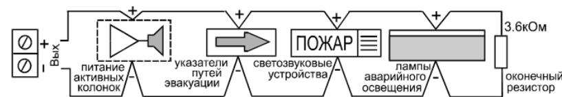
Рис.2 – Схема подключения нагрузок к выходам
