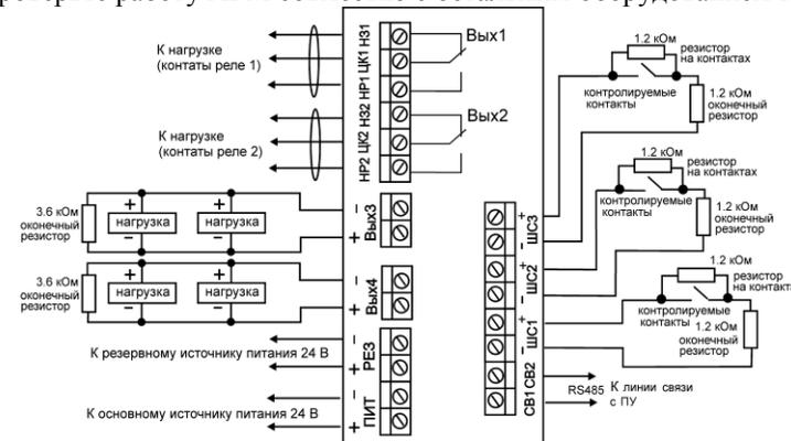
Рис.11 – Монтажная схема АРМ
