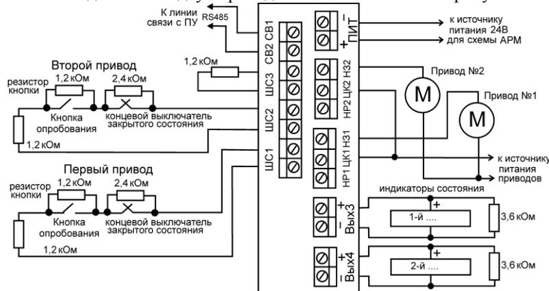
Рис.4 – Схема подключения АРМ в режиме 2
