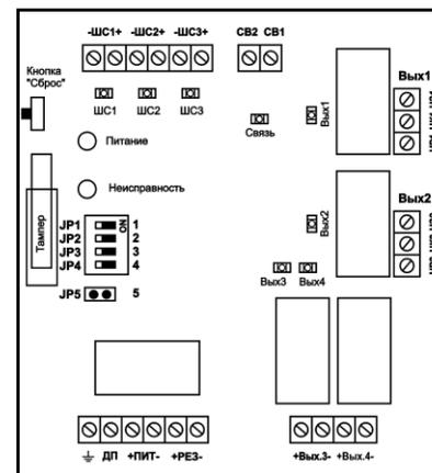
Рис.3 – Расположение индикаторов, кнопки «Сброс», движковых переключателей JP1–JP4 и перемычки JP5 на плате АРМ
